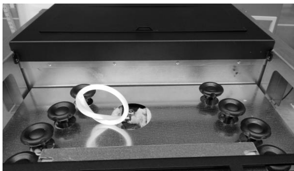
Figura 21 - Limpeza dos turbuladores
