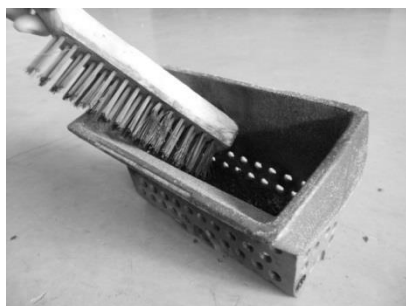
Figura 24 - Limpeza do cesto de queima
