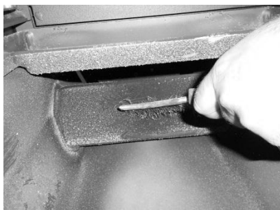
Figura 34 - Limpeza do interior da salamandra a água
