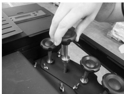
Figura 33 - Limpeza dos turbuladores
