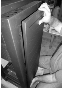
Figura 23 - Remoção das capas laterais
