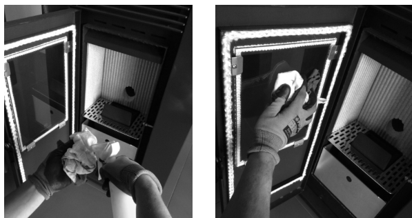
Figura 45 - Limpeza do vidro: a) aplicar líquido no pano; b) limpar o vidro com o pano
