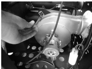
Figura 42 - a) Retirar os parafusos; b) Retirar extractor
