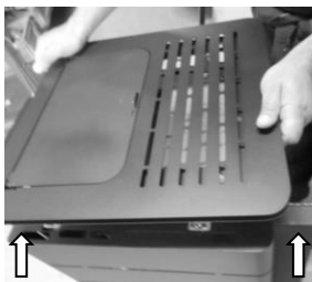
Figura 14 – Remoção tampo superior
