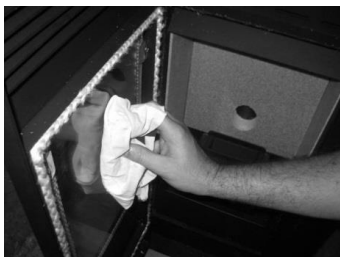
Figura 64 – Limpeza do vidro: Limpar o vidro com o pano
