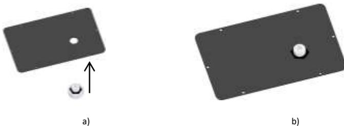
**Figura 17 – Fixação do sensor de nível na peça**
