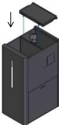
**Figura 11 – Colocação das tampas superiores**
