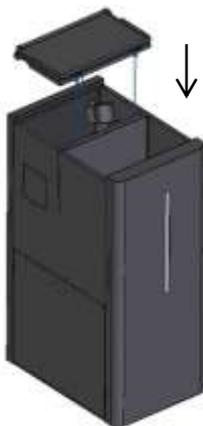
**Figura 25 – Colocação das tampas superiores**
