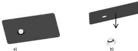
**Figura 16 – Remoção do sensor de nível da tampa**
