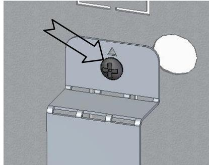
**Figura 7 – Marca triangular do módulo**
